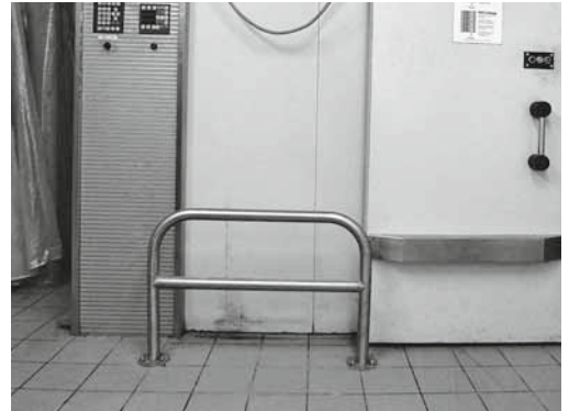
Fig. 2: protection contre les risques d'endommagement.
